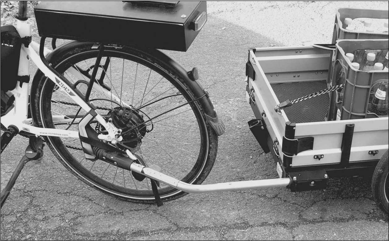
Weber B-Kupplung an der Sitz- und Kettenstrebe. Bei diesem Pedelec kam wegen des Hinterrad-antriebs keine Hinterradnabenbefestigung in Frage und andere Befestigungspunkte waren nicht vor-handen.
